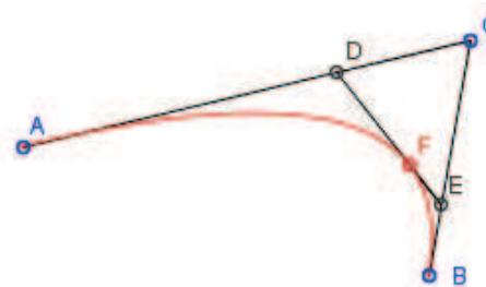
Ovdje je točka  $F$  diralište. Uključimo li mogućnost ostavljanja traga te točke pri promjeni vrijednosti parametra  $t$ , točka  $F$  će „pisati“ krivulju. Istu krivulju moguće je dobiti kao *Lokus*. Za funkciranje naredbe *Lokus* potrebne su dvije zavisne točke. Zato je umjesto parametra  $t$  definiranog preko klizača, potrebno redefinirati parametar  $t$  preko točke koja pripada nekoj dužini. Zadajmo dužinu  $\overline{PQ}$  i na njoj točku  $R$  i definirajmo parametar  $t$  naredbom:
