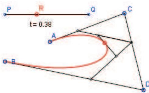
Dodamo li konstrukciji još jednu kontrolnu točku, a princip konstrukcije proširimo kao na slici 4, dobit ćemo Bézierovu krivulju **trećeg reda**, s kojom je već moguće oblikovati petlju. Po istom načelu konstrukciju možemo dalje usložnjavati na više redove.
